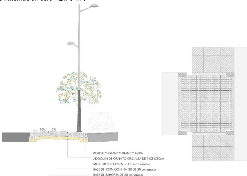
Figura 4. Detalle pavimentación elevada en cruces
